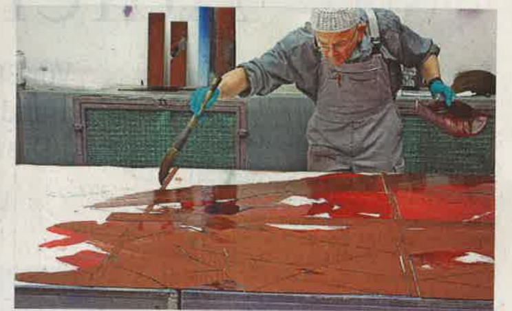
Sechs Farben trägt Max Uhlig im Glasstudio Derix in Taunusstein auf die Scheiben auf. Sie liegen auf einem Lichttisch. Jede Farbe wird einzeln gebrannt.
